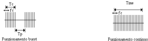
Fig. 9.2 – Corrente rettangolare in funzionamento burst tipo azione-pausa ( T.Contr. diverso da “CNT”) o in funzionamento continuo ( T.Contr. = “CNT”)
